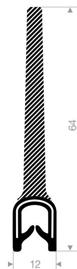
VR24500865 PVC & Moosgummi Spannbereich 1-2,5 mm Rollenlänge 50 Meter
