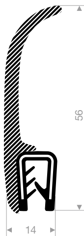
VR24500876 PVC & Moosgummi Spannbereich 1-3 mm Rollenlänge 25 Meter
