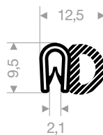
VR24500135 PVC & Moosgummi Spannbereich 1-2 mm Rollenlänge 50 Meter
